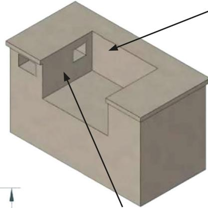
Einbauort des Controllers (ITC): 230V 50Hz Stromversorgung innerhalb von 3,05m erforderlich. HINWEIS: Der Einbauort des ITC-Controllers ist nur exemplarisch dargestellt. Das Controller-Kabel ist 3,05m lang, so dass die Controller (ITC) nach Ihren Vorgaben an einer Vielzahl von Positionen montiert werden.
