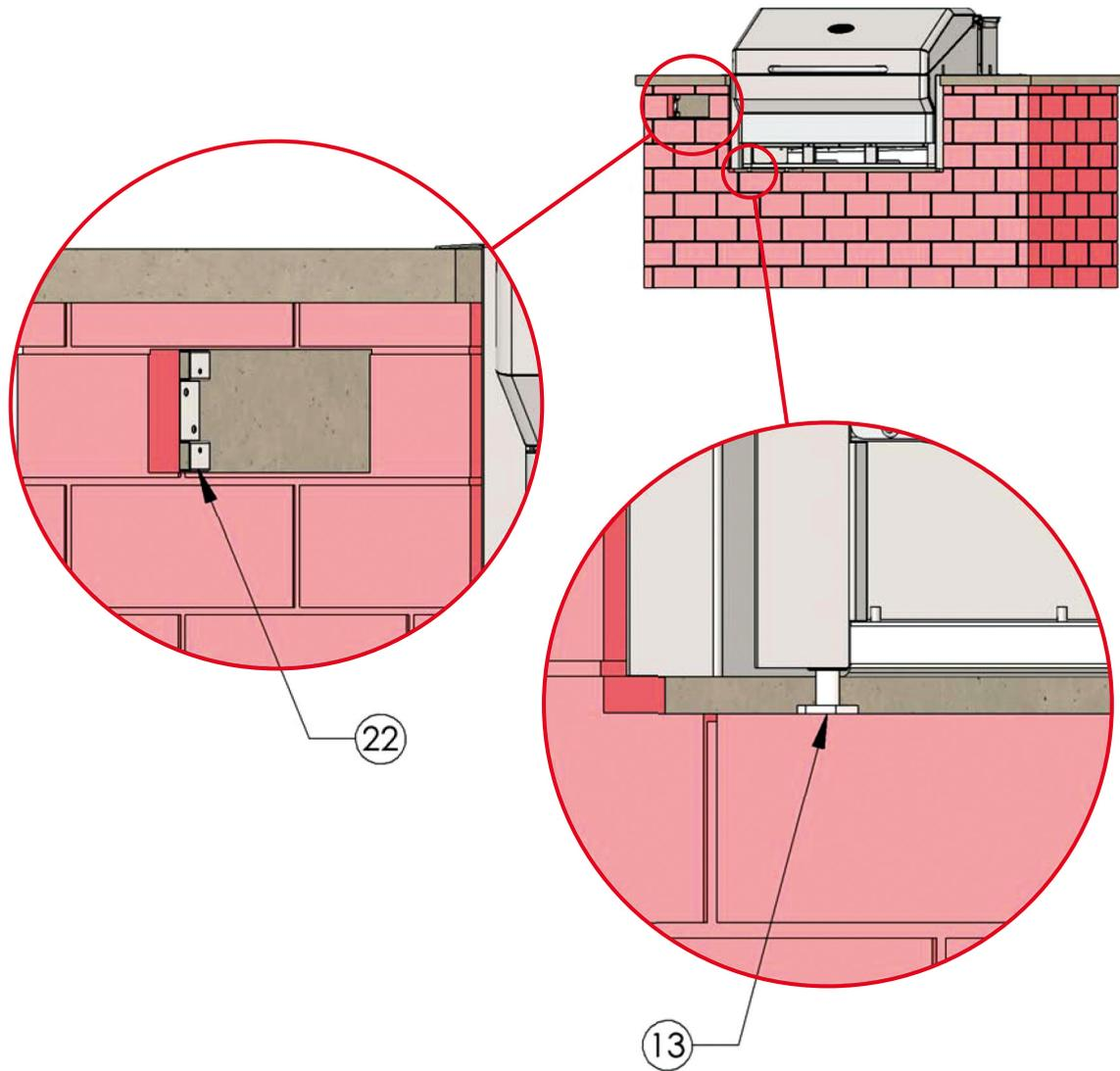
1. Befestigen Sie die beiden Controller-Halterungen (Teil 22) in der Controller-Kabeldurchführung in der gewünschten Tiefe. Nutzen Sie für das Material geeignete Befestigungselemente. Verwenden Sie pro Halterung zwei Befestigungselemente. (Diese sind nicht im Lieferumfang enthalten.)
