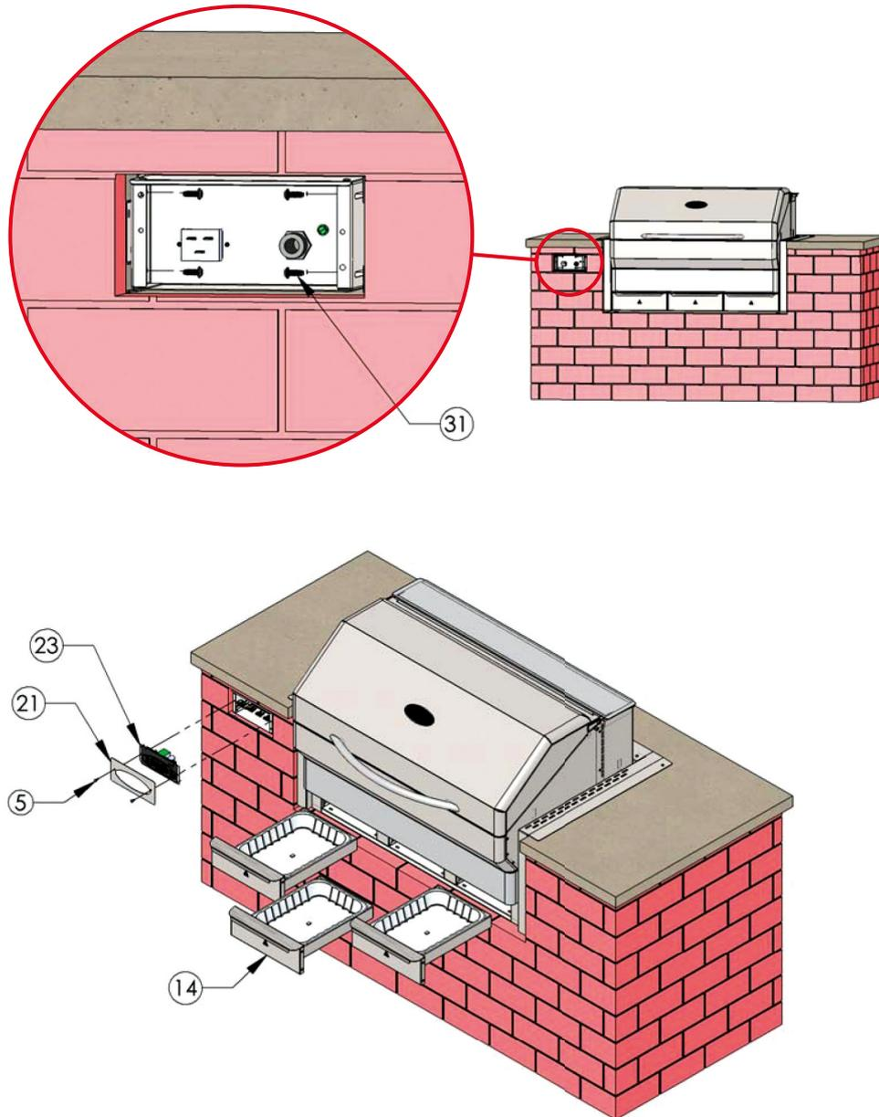
1. Entfernen Sie den ITC-Controller (Teil 23) aus der Controller-Box.
